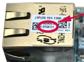
Harmonia 2 : Sur le connecteur RJ45 Prendre les 6 derniers chiffres de l'adresse MAC
